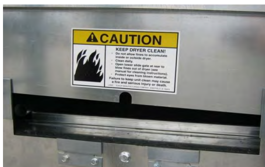
Image 25 – Plenum cleanout/blowout door
