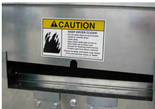
Image 30 – Plenum cleanout/blowout door
